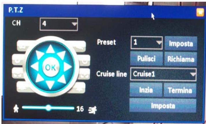
Occorre scegliere la telecamera ed agire sui pulsanti di comando a sinistra per regolare spostamenti, zoom, fuoco e iris. La regolazione da 1 a 16 in basso a sinistra permette di scegliere la velocità di spostamento. Nel pannello a destra è possibile impostare e richiamare i preset (prezisionamenti) ed i principali movimenti automatici.
