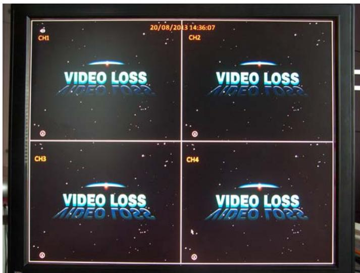
All'avviamento del DVR viene proposta la multivisione contemporanea delle telecamere con la divisione dello schermo in 4, 9 o 16 riquadri a seconda del modello in esame. Se in questa fase le immagini delle telecamere non appaiono nei riquadri controllare collegamenti e alimentazioni per verificare la presenza del segnale video. Verificare inoltre di non utilizzare telecamere analogiche normali con DVR di tipo HD-SDI o viceversa.
