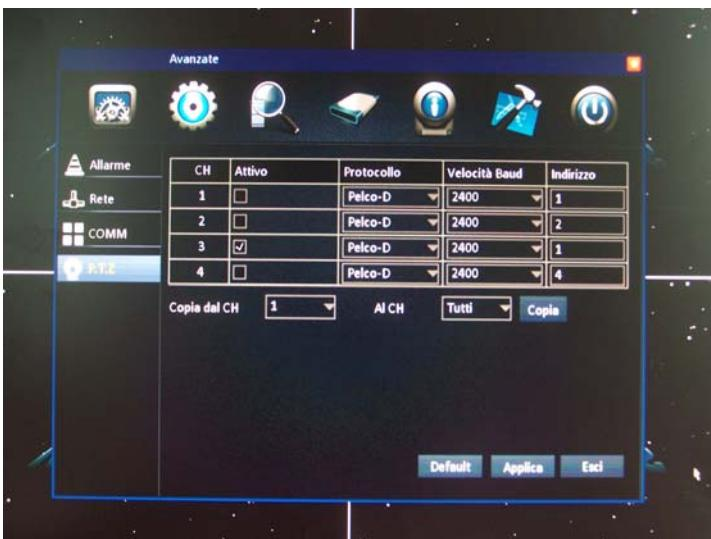
I DVR serie DH sono in grado di controllare il movimento di telecamere motorizzate speed-dome attraverso il mouse, la tastiera del DVR e persino da collegamento remoto con il browser o con
