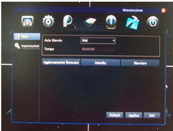
In questa sezione è possibile effettuare alcune operazioni di manutenzione del DVR AUTO RIAVVIO – E' possibile impostare il riavvio automatico del DVR con una cadenza periodica ogni giorno, ogni settimana o ogni mese. La stabilità del firmware dei DVR serie RH rende questa programmazione di regola non necessaria per cui è consigliabile lasciare l'impostazione di fabbrica MAI
