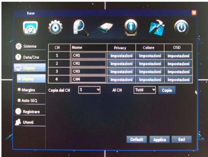
Per ogni canale è possibile impostare la modalità di visualizzazione a schermo NOME – E' possibile inserire un nome personalizzato per ogni telecamera PRIVACY – Cliccando questo pulsante è possibile mascherare una o più aree nell'immagine ripresa. In genere si opera questo mascheramento per la protezione della privacy ad esempio nella sorveglianza dei posti di lavoro. Appare
